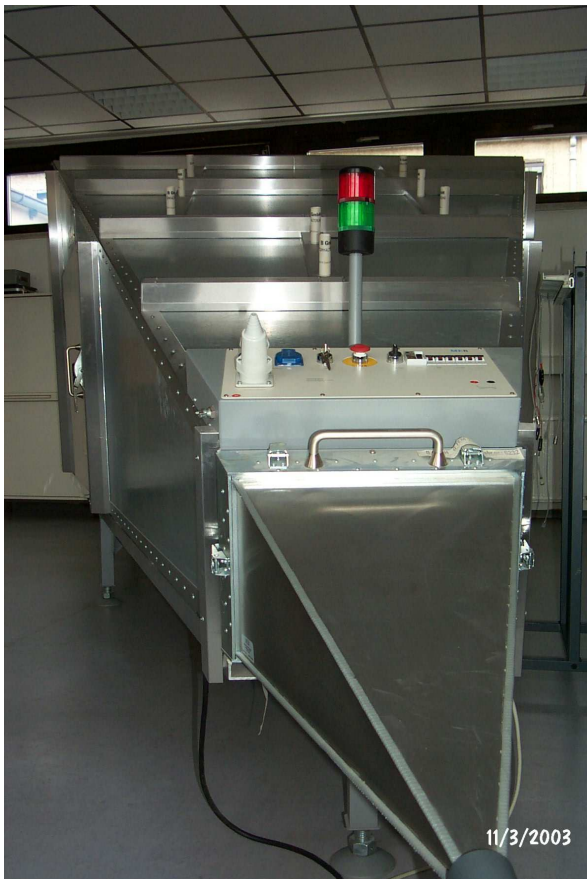
Abb. 29: Foto: GTEM- Zelle FHTW Berlin
