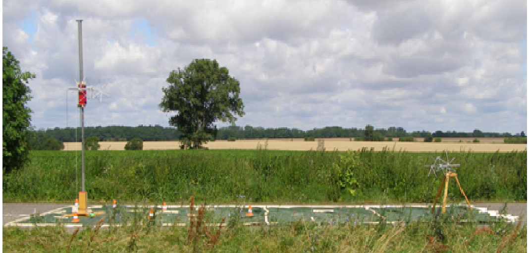
Abb. 30: Foto: Messaufbau Messplatzdämpfung, 10 m- Strecke Altlandsberg
