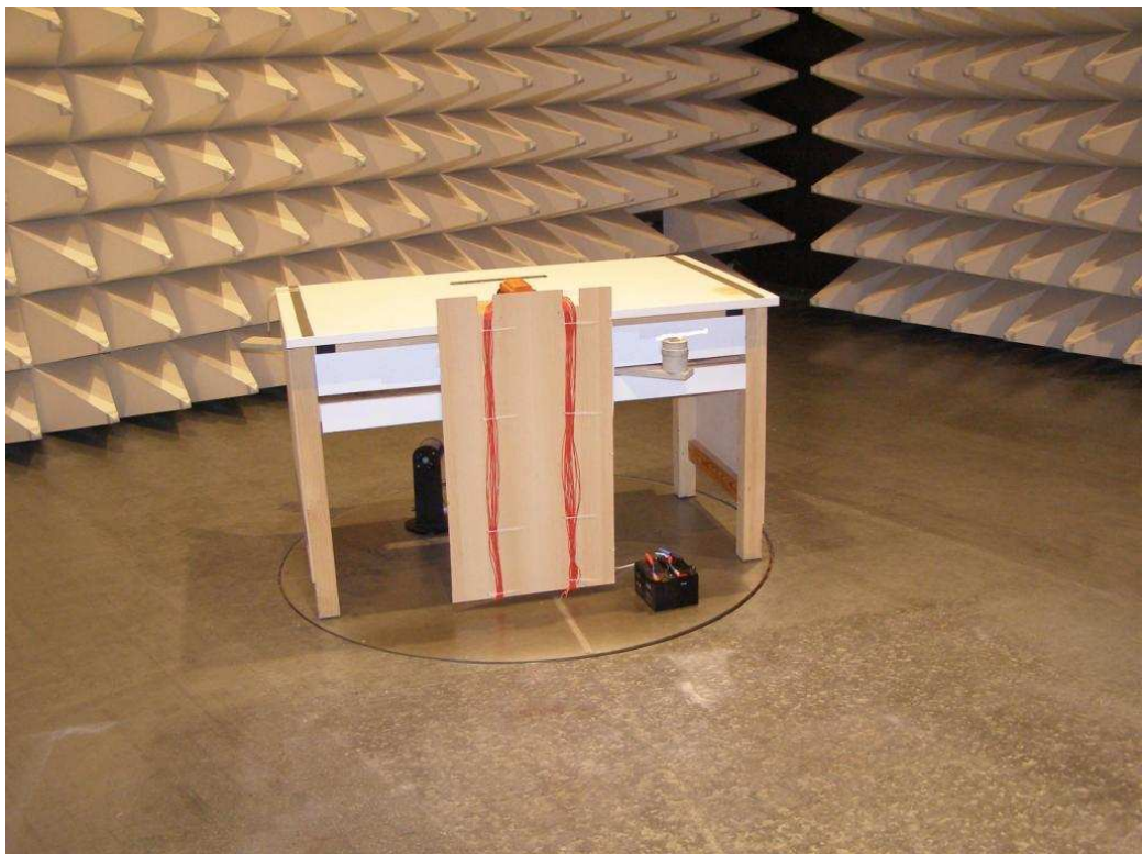
Abb. 27: Foto: 3 m- Absorberhalle Messlabor P mit realem Prüfling
