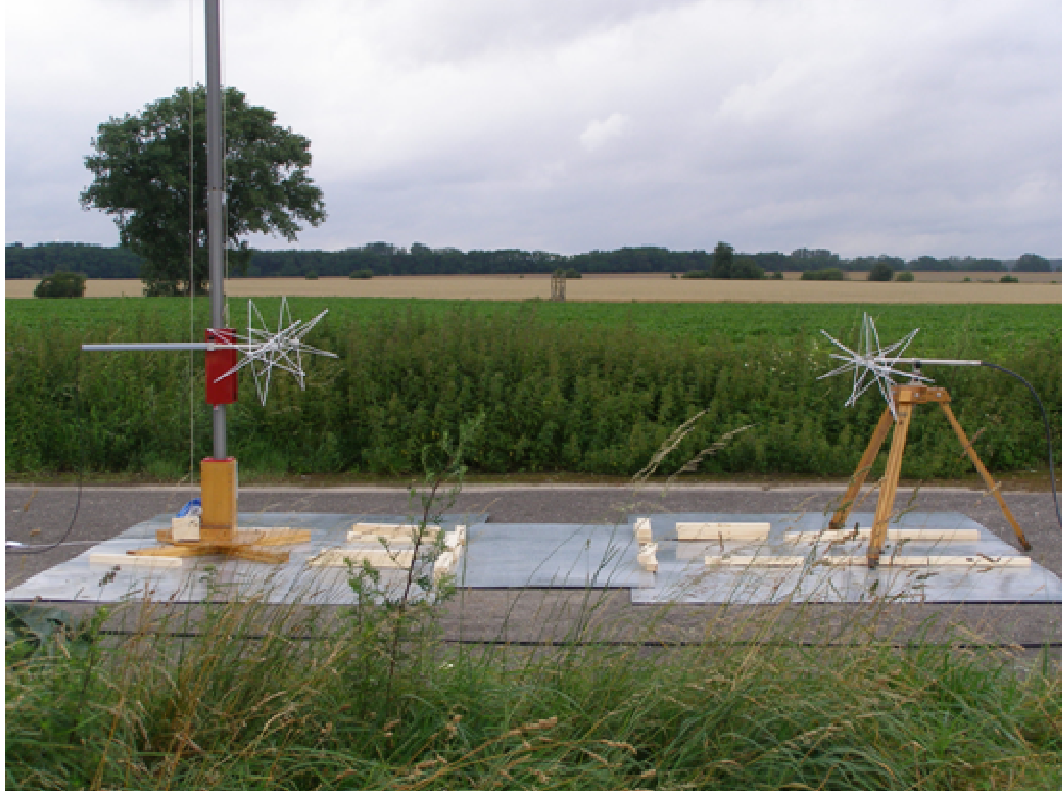
Abb. 31: Foto: Messaufbau Messplatzdämpfung, 3 m- Strecke Altlandsberg
