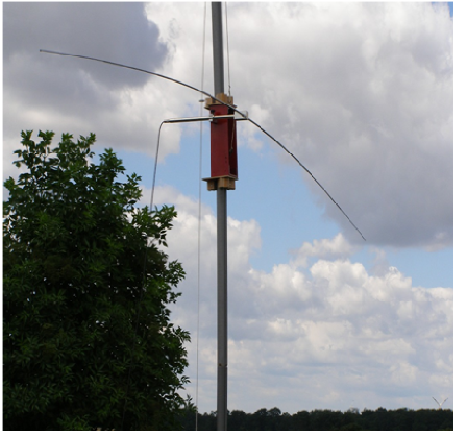
Abb. 34: Fotos: Messung mit Präzisions- Dipolen, Altlandsberg
